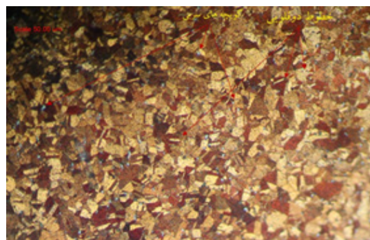
شکل ۵. ریزساختارها قبل از اچ، شامل آخال‌های سولفیدی، گویچه‌های سربی و... بزرگنمایی دو تصویر ۱۰۰ برابر منبع: نگارنده
