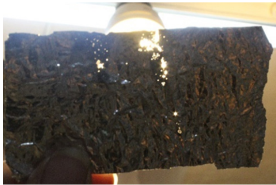
شکل ۴. تصویر آلومینیوم سوراخ شده توسط کلرید آلومینیوم در آزمون رزبرگ-منبع نگارنده
