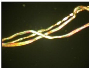
شکل ۸: تصویر میکروسکوپی نمونه‌ی شماره دو با نور پلاریزان و شناسایی لیف پنبه
