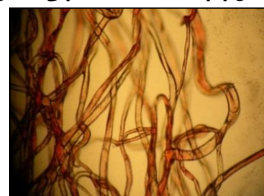
شکل ۱: تصویر میکروسکوپی نمونه‌ی شماره یک با نور معمولی و شناسایی لیف پنبه
