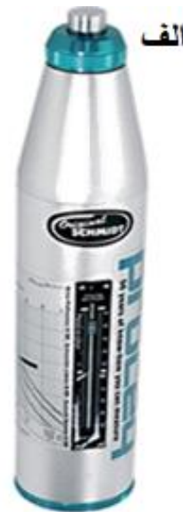
شکل ۲. الف) چکش اشپیت نوع L استفاده شده؛ ب) اندازه گیری سختی و اجپشی با چکش اشپیت روی سطوح هوازده کندوان.
