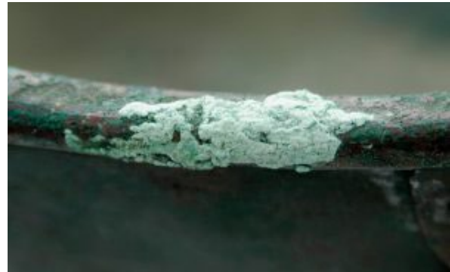
شکل ۷. شکل خوردگی کلریدی روی کاسه‌ای از جنس آلیاژ مس (نگارندگان) Figure 7. Chloride color pattern on a copper alloy bowl. (by Authors).
