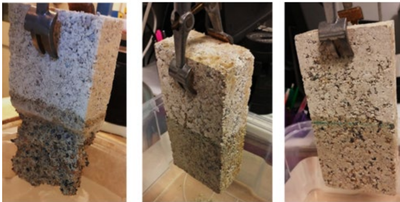
شکل ۲. شرایط آجرها بلافاصله پس از خارج کردن از آب. این تصویر می‌تواند به وضوح تفاوت‌های ظاهری و وضعیت فیزیکی آجرها را پس از قرارگیری در معرض آب نشان دهد که به ارزیابی عملکرد آن‌ها در برابر رطوبت کمک می‌کند. شکل چپ: نمونه درمان نشده. وسط: صمغ گوار و راست: صمغ زانتان (Muguda-Viswanath, 2019)
