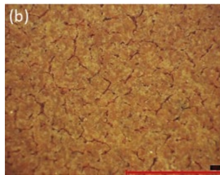
شکل ۴. مشاهده سه بعدی نمونه تیمار شده با سیلان (پس از چرخه‌های ذوب و انجماد و تصویر میکروسکوپ الکترونی روبشی (SEM) از همان نمونه) SN (تصویر b) ساختار سطح و تغییرات ناشی از تیمار را نشان می‌دهد. (Stefanidou & Karozou, 2016)
