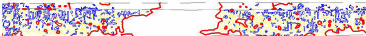
شکل ۱۵. طرح آسیب شناسی کتیبه گچبری جبهه جنوبی مسجد آق قلعه نقاب سبزوار (عکس از نگارنده) خطوط آبی: خطوط گچبری های به جای مانده، خطوط زرد: داغ خطوط گچبری های به جای مانده، خطوط قرمز: ریزش بخش های مختلف، کتیبه گچبری
