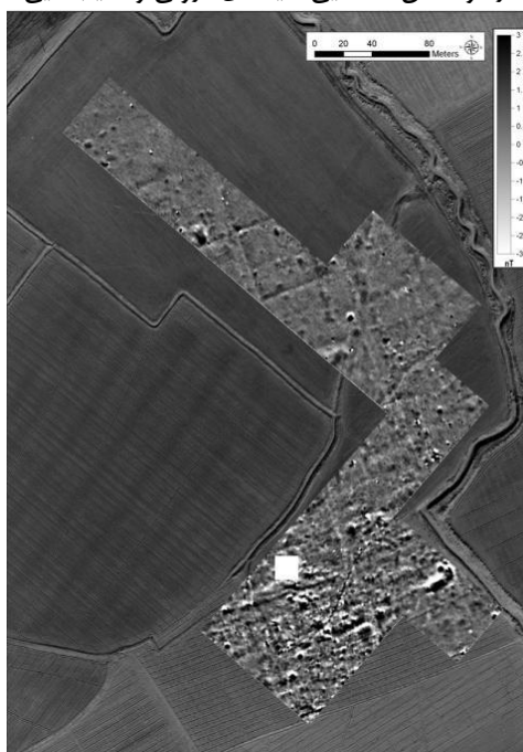
شکل ۴. نقشه ژئومغناطیس زمینه‌ای اطراف تخت جمشید که بدون حفاری و فقط با اندازه‌گیری شدت و جهت میدان مغناطیسی توسط دستگاه گرادایومتر به دست آمده و ساختارهای معماری و بناهای متعددی را آشکار کرده است (بحرالعلوم، ۱۳۹۳)
