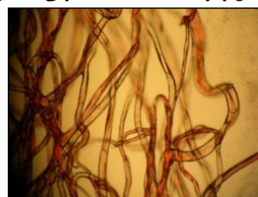
شکل ۱: تصویر میکروسکوپی نمونه‌ی شماره یک با نور معمولی و شناسایی لیف پنبه
