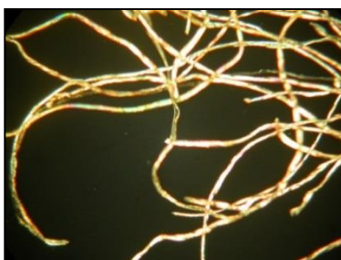
شکل ۱۴: تصویر میکروسکوپی نمونه‌ی شماره دو با نور پلاریزان و شناسایی لیف پنبه
