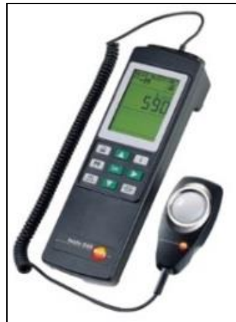
شکل ۲۷: دستگاه نورسنج، مدل Testo lux meter 545، مورد استفاده در پژوهش حاضر
