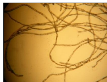
شکل ۱۳: تصویر میکروسکوپی نمونه‌ی شماره دو با نور پلاریزان و شناسایی لیف پنبه
