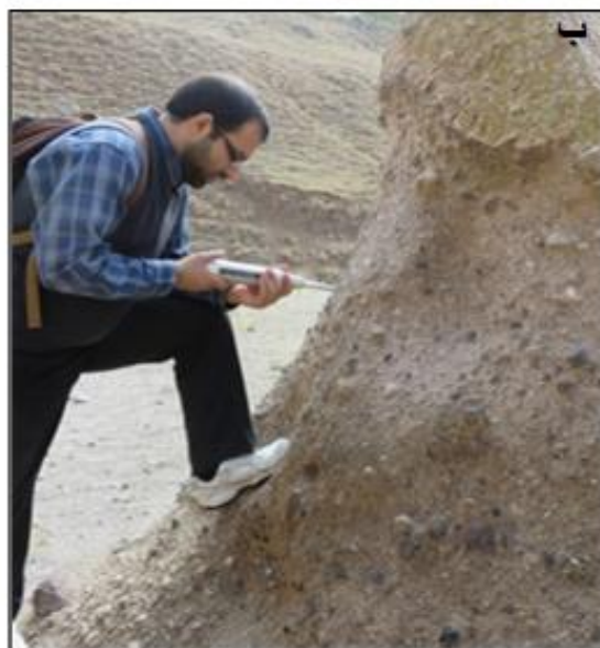
شکل ۲. چکش اشمیت نوع L استفاده شده؛ (ب) اندازه‌گیری سختی واجهشی با چکش اشمیت روی سطوح هوازده کندوان.
