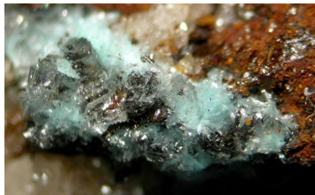
شکل ۵. کالکوناترونیت از دیگر کربنات‌های مس است که در نتیجه واکنش نمک‌های مس موجود در محصولات خوردگی اشیای مدفون، یا بر اثر واکنش مستقیم آلیاژ مس با کربنات‌های سدیم موجود حاصل می‌شود (نگارندگان) Figure 5. Calconatronite is another copper carbonate that results from the reaction of copper salts present in the corrosion products of buried objects, or from the direct reaction of copper alloy with existing sodium carbonates (Authors)
