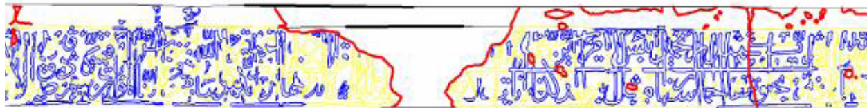
شکل ۱۹. طرح آسیب شناسی کتیبه گچبری جبهه شرقی مسجد آق قلعه نقاب سبزوار (عکس از نگارنده)
